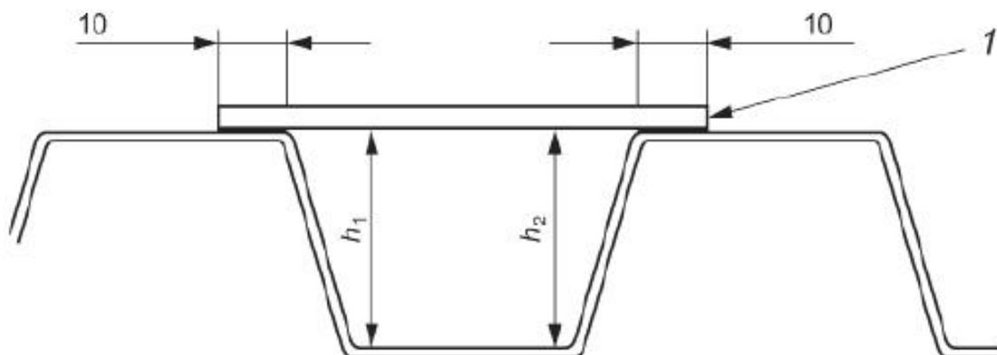
1 - линейка;  $h_1$ ,  $h_2$  - измеряемая глубина профиля;  $h = (h_1 + h_2) / 2$
