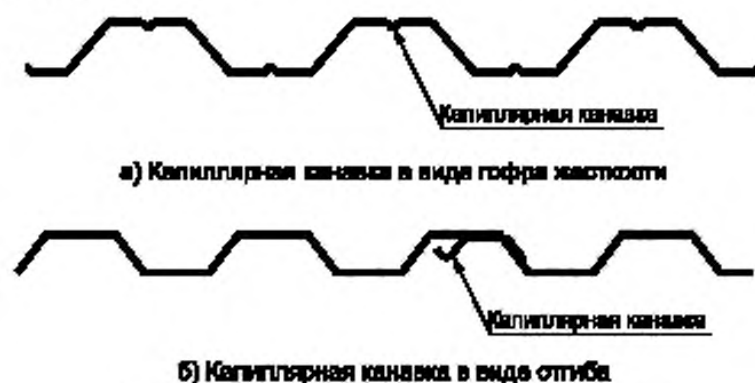
Рисунок 3 — Основные виды капиллярных канавок
